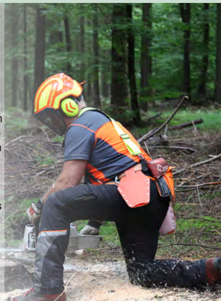
Ein ausreichender Schutz der Gesundheit vor Motorsägenlärm ist bei manchen neueren Motorsägen mit den üblichen Gehörschützern nicht mehr selbstverständlich.
