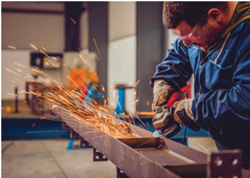
Jeder Bauhof hat ihn, jede Metallwerkstatt arbeitet mit ihm, fast jeder Handwerker benutzt ihn. Der Winkelschleifer! Es ist ein praktisches Gerät, um Werkstoffe zu schneiden oder Oberflächen zu bearbeiten. Es gibt viele handgeführte Modelle, die über eine Schleifscheibenaufnahme von üblicherweise 115 mm über 125 mm bis zu 230 mm verfügen.
