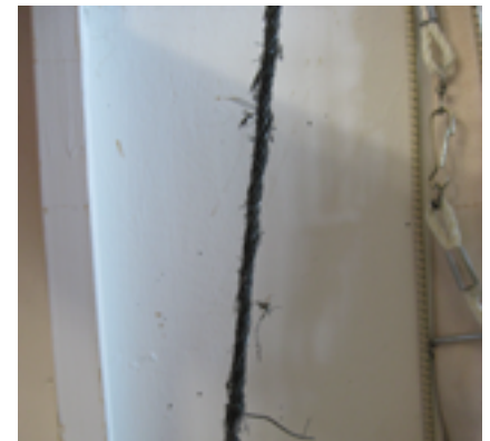
Ein völlig verschlissenes Tragseil hängt quasi am seidenen Faden. Das Tor wurde seit vielen Jahren weder fachgerecht überprüft noch gewartet.
