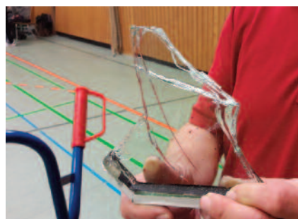
Abb. 1 u. 2: Unfallsituation – komplett zerstörte obere Türverglasung und Bruchbild der nicht sicheren Verglasung. Mit Sicherheitsglas wären die Verletzungsfolgen gering gewesen.
