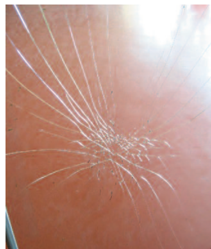
Abb. 7: VSG-Bruchbild – es ist splitterbindend und durchbruchhemmend.
