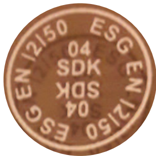
Abb. 4: ESG – Kennzeichnungsbeispiel: hier DIN 12150; Weitere Erkennungsmerkmale von Sicherheitsglas sind Aufdrucke mit „DIN 1249“ sowie von Herstellern wie z. B. „Sekurit“.
