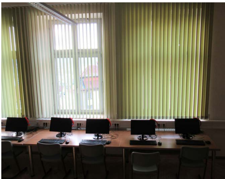
Abb. 5 und 6: Blendung durch Gegenlicht an einem nebligen Tag (Hochnebel). Ausrichtung der Bildschirme parallel zur Fensterfront. Unterschied zwischen Verdunkelung und Blendung mit Lichtreflexen über die Tischflächen.
