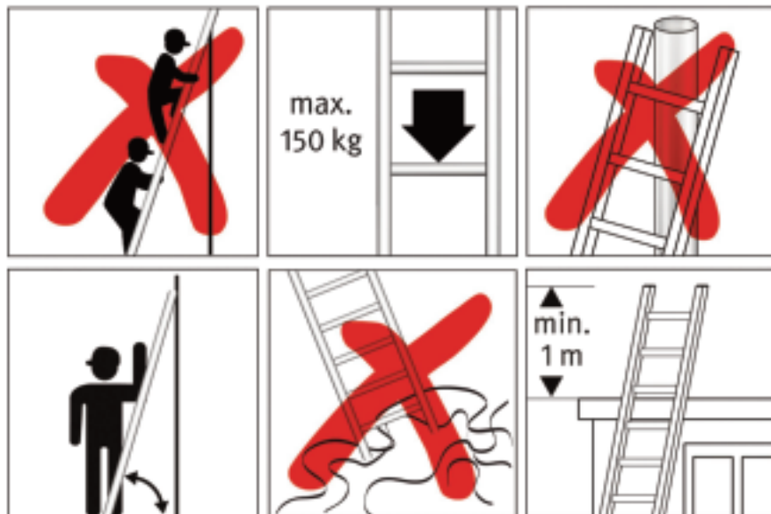
Abb. 3: Die Pictogramme an Leitern geben Auskunft über Sicherheits- und Benutzungshinweise.
