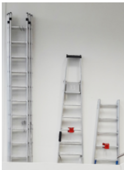
Abb. 4: Vorbildliches „Leiter-Management“: Hier ist jederzeit die richtige und für die Arbeitsaufgabe geeignete Leiter schnell verfügbar. Die beiden rechten Leitern (Stehleitern) sind für die Nut- zung als Anlegeleitern nicht zulässig! Alle Leitern sind gegen Diebstahl / unbefugte Benutzung gesichert.
