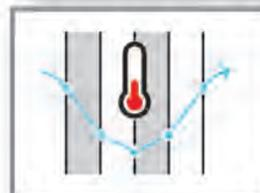
Beim Stoß- und Querlüften sinkt die Raumtemperatur nur um wenige Grad ab und steigt nach dem Schließen der Fenster schnell wieder an.
